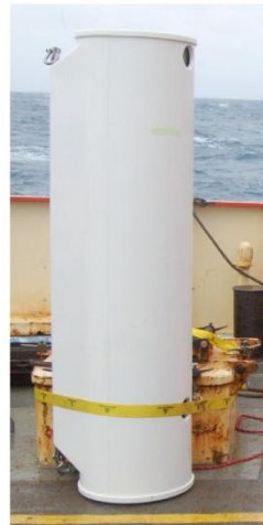
Trampa de sedimento Technicap PPS3/3.
