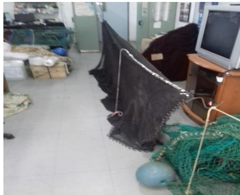
Figura 37. Construcción de uno de los blindajes internos construido en hilo de poliamida.
