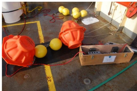
Boyas Nautilus y boyas castro, en caja CTD microcat SBE-37-ODO.
