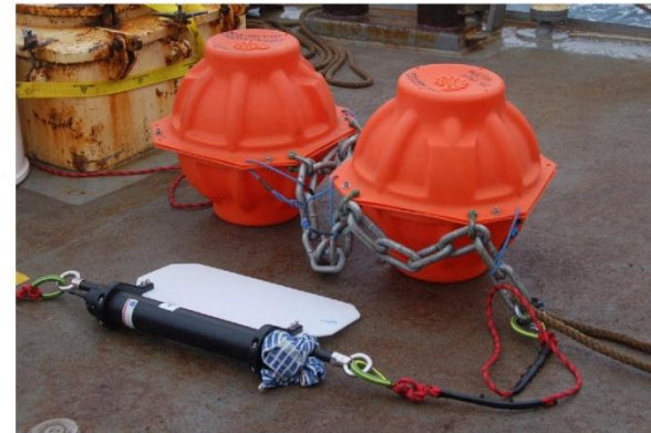
Boyas Nautilus y correntómetro monopunto Aquadopp 3000 con aleta giratoria Aquafin.
