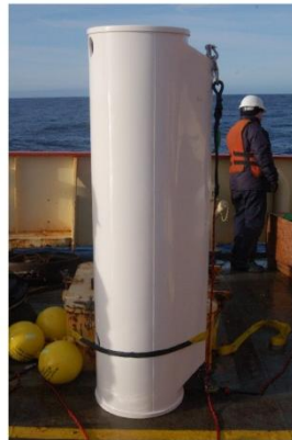
Trampa de sedimento Technicap PPS3/3.
