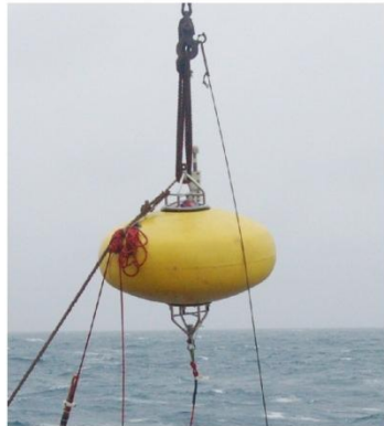
Boya oceanográfica, armada con un perfilador de corrientes TRDI WHS 300 kHz, logger de clorofila Cyclops-PME y baliza Iridium Novatech.
