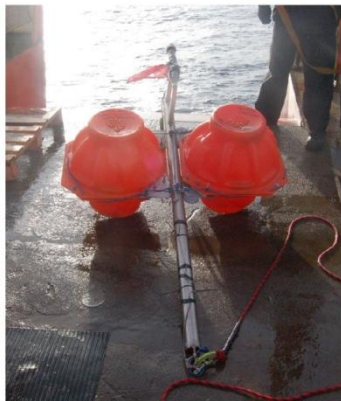
Tren de flotación formado por boyas Nautilus y baliza Iridium Novatech.
