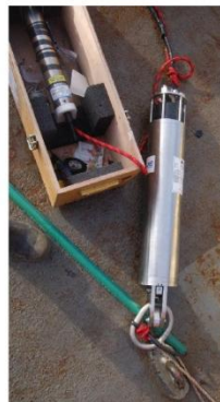
CTD microcat SBE-37-ODO y liberador Acústico OCEANO 2500 (ixBlue).
