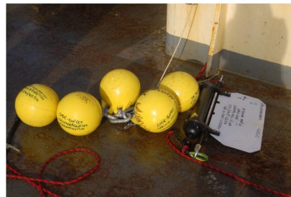
Boyas Castro y correntómetro monopunto Aquadopp 3000 con aleta giratoria Aquafin.
