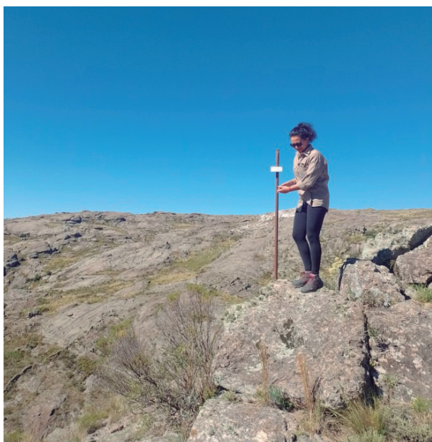
Recambio de detectores de gas radón en aire en alrededores del ex complejo minero fabril Los Gigantes, provincia de Córdoba
