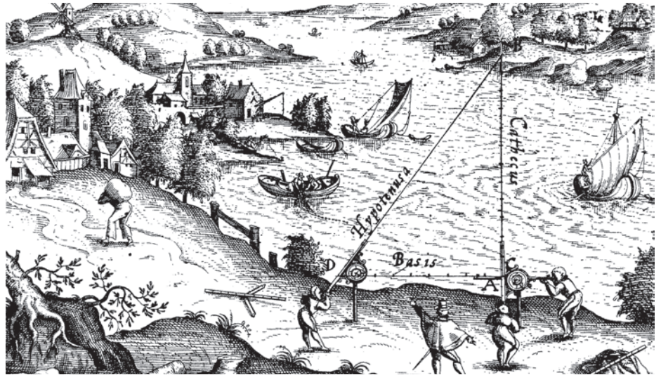
Mechainek eta Delambre triangulazio sistema bat erabili zuten Lurra neurtzeko eta metroa aurkitzeko.
