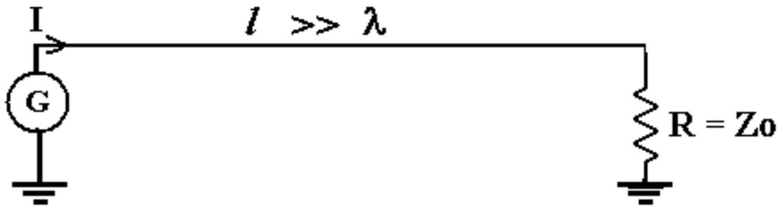
Quanta corrente o potenza arriva al termine della linea? Un conduttore, di lunghezza paragonabile o maggiore della lunghezza d'onda irraggia! E' un'antenna! Se il conduttore è abbastanza lungo, irraggia quasi completamente la potenza immessa e nessuna corrente arriva al terminale della linea, tanto che può essere lasciato libero o, meglio, chiuso direttamente a terra.
