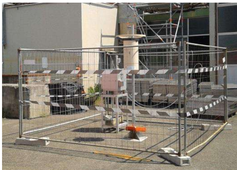
Figura 2 – Configurazione dei campionatori in una delle postazioni di monitoraggio.
