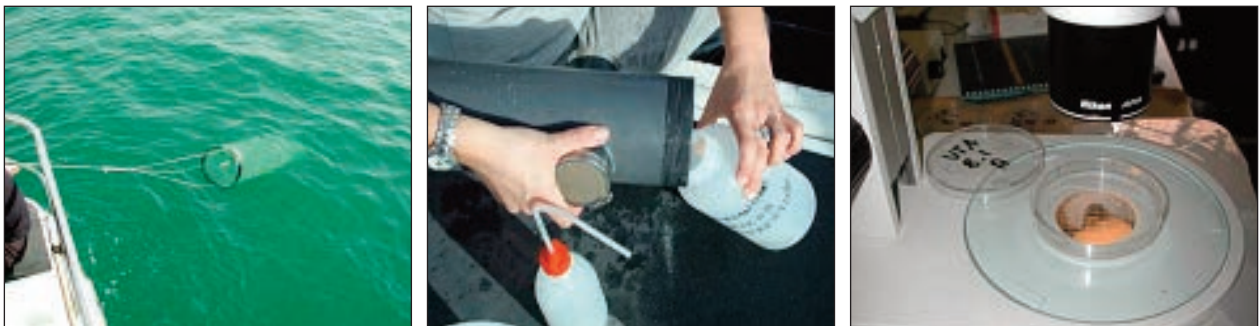
Fig. 3 - Fasi del campionamento e analisi dello zooplancton. A sinistra il retino WP2, al centro il recupero degli organismi dal collettore posto in fondo alla rete, a destra l'analisi tassonomica allo stereo microscopio
