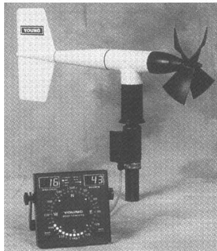
Fig.2.569 - Anemometro ad elica monoassiale
