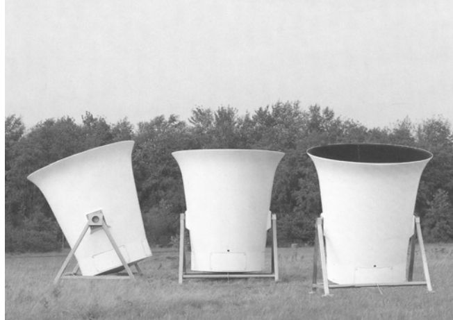
Fig. 2.63: SODAR tradizionale (Metek – GmbH)
