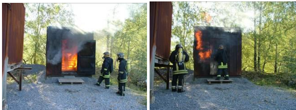
Abbildung 9 a und b: Ein Brand entwickelt sich bis der im Brandraum enthaltene Sauerstoff vom Feuer verbraucht wurde. (Foto: Kortenhof, Leipzig, ecomed-Storck GmbH);
