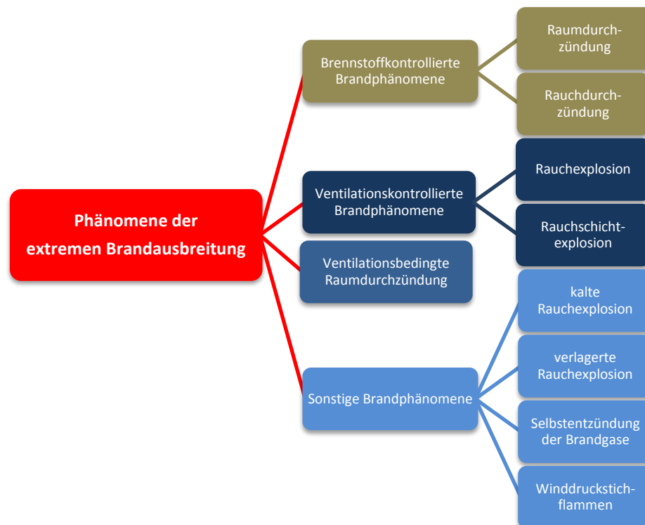
Abbildung 1: Modell für die Phänomene der extremen Brandausbreitung basierend auf den deutschen Definitionen (Abbildung: Volkmar, ecomed-Storck GmbH, bearbeitet von Vöge, IdF NRW)
