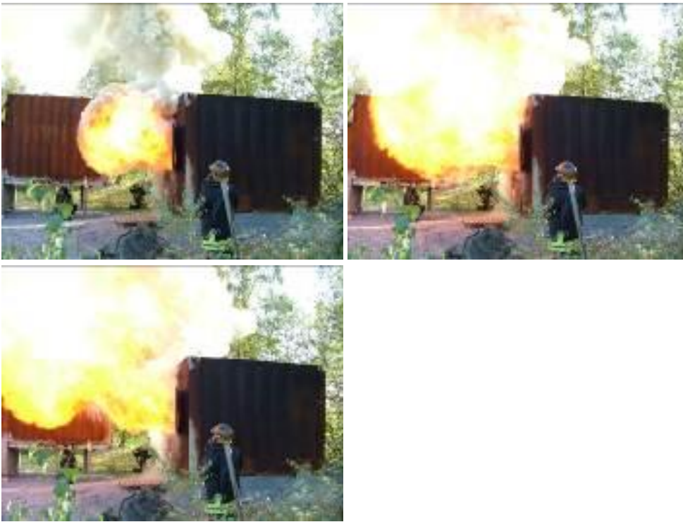
Abbildung 10 a - c: Rauchexplosion (backdraft) (Foto: Kortenhof, Leipzig, ecomed-Storck GmbH)
