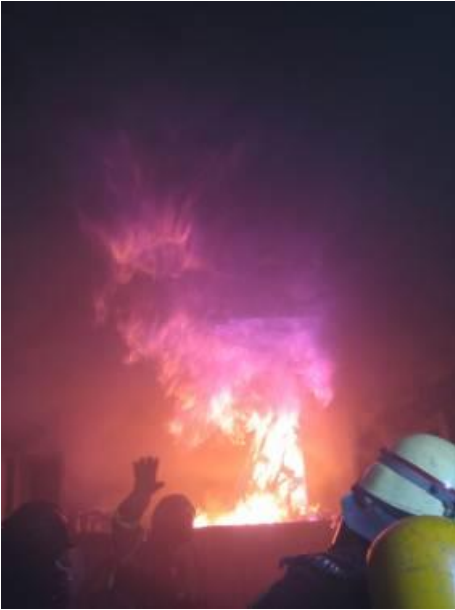
Abbildung 7: Rauchdurchzündung dargestellt in einer Brandübungsanlage. (Foto: Fuchs, ecomed-Storck GmbH)
