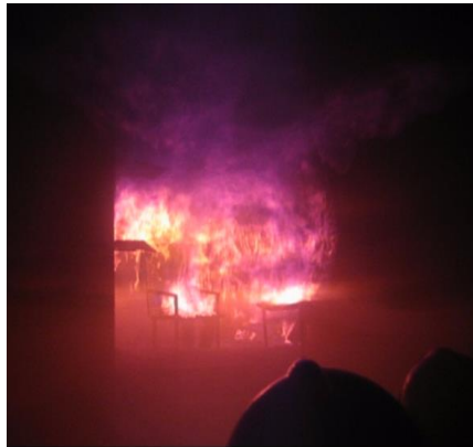
Abbildung 4 b: Simulierter Raum im Übungscontainer: nach der Raumdurchzündung sind noch der durchgezündete Sessel, Tisch und Regal zu erkennen. (Foto: Fuchs, SCB Boxmeer, Niederlande, ecomed-Storck GmbH)
