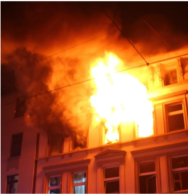
Abbildung 5: Vollbrandphase: über den Zustand der Raumdurchzündungsphase hinaus ist hier das komplette Raumvolumen mit Flammen gefüllt. (Foto: Fichte, Wuppertal, ecomed-Storck GmbH)
