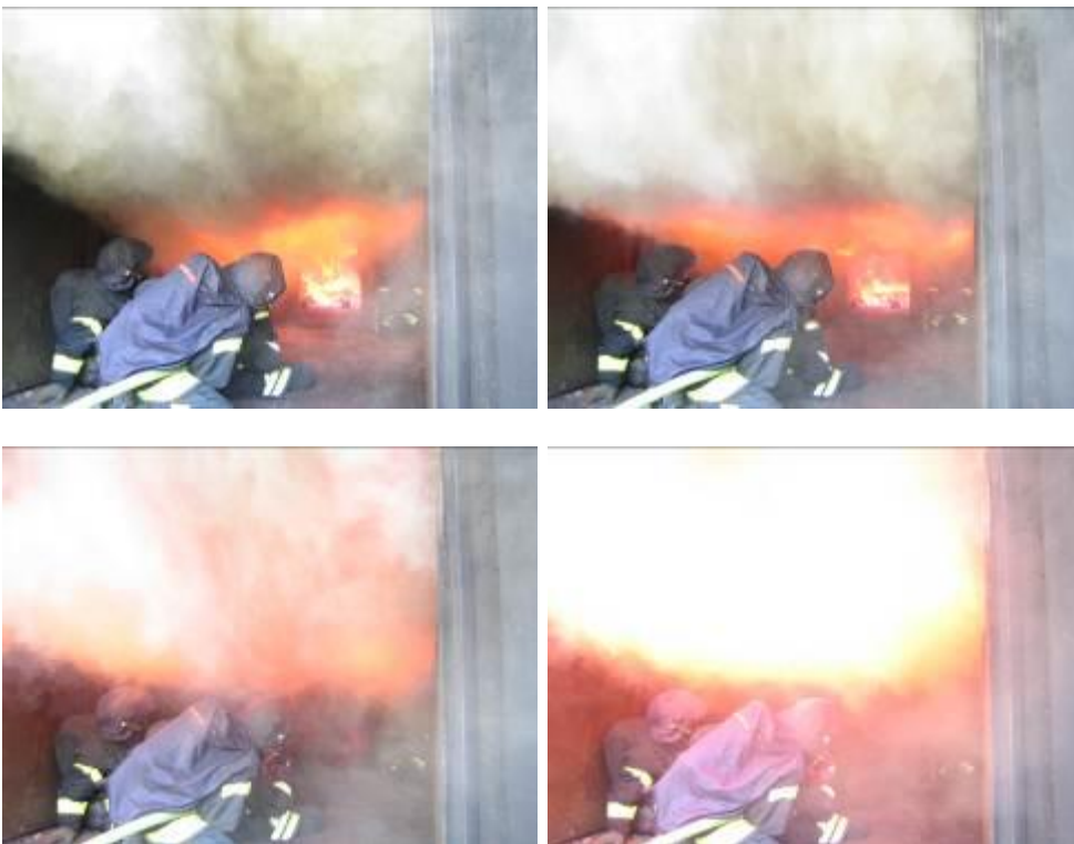
Abbildung 11 a - d: Rauchschichtexplosion im Raum vor dem Brandraum. (Foto: Fuchs, Wuppertal, ecomed-Storck GmbH)
