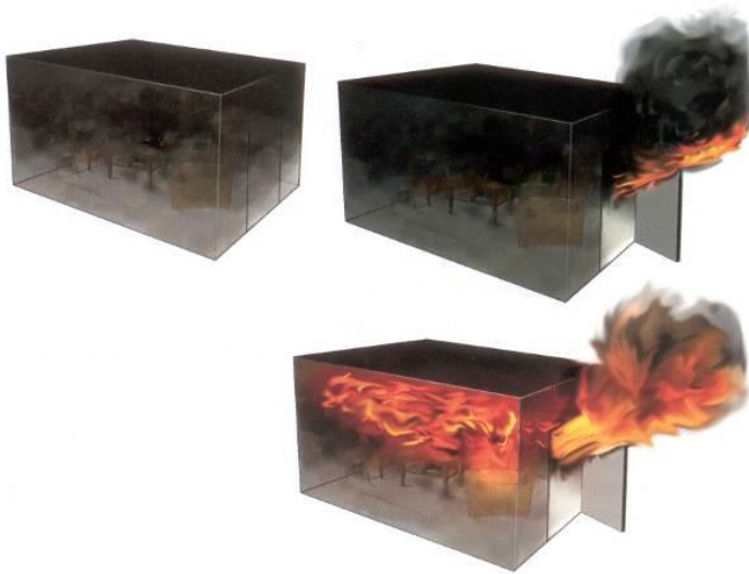
Abbildung 20: Ablauf der Selbstentzündung heißer Pyrolysegase nach dem Öffnen einer Tür. (Grafik: Bengtsson, 2001, ecomed-Storck GmbH)
