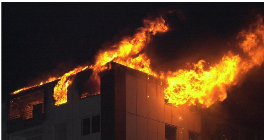
Abbildung 21 a und b: Typisches Erscheinungsbild von Winddruckstichflammen (Fotos: W. Westerholz, Wuppertal, ecomed-Storck GmbH)
