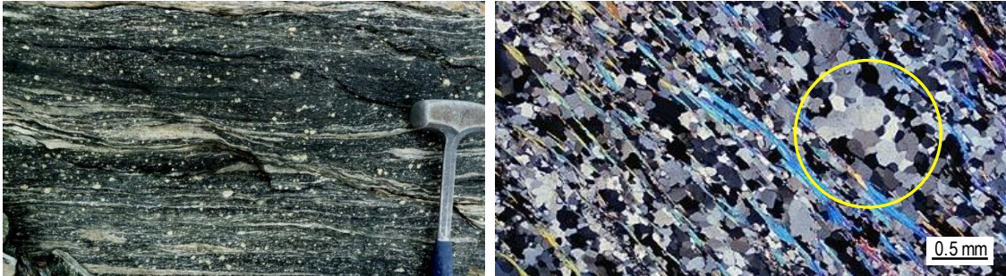
A la izquierda, ultramilonita con importante reducción del tamaño de grano de los minerales; a la derecha, esquistos de cuarzo-muscovita donde los cristales de cuarzo forman arreglos poligonales a \sim 120^\circ (círculo). Imágenes 3,4 .
