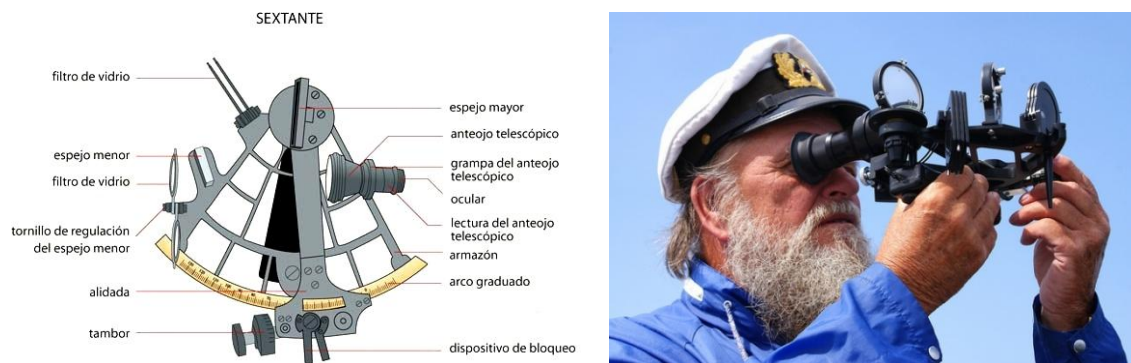
El sextante, instrumento de posicionamiento. Imágenes 3 .
