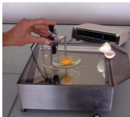
Bild unten: Elektronische Messapparatur, wie sie zur stichprobenweisen Erhebung der Haugh-Einheiten bei den Eiersammelstellen zum Einsatz kommt.
