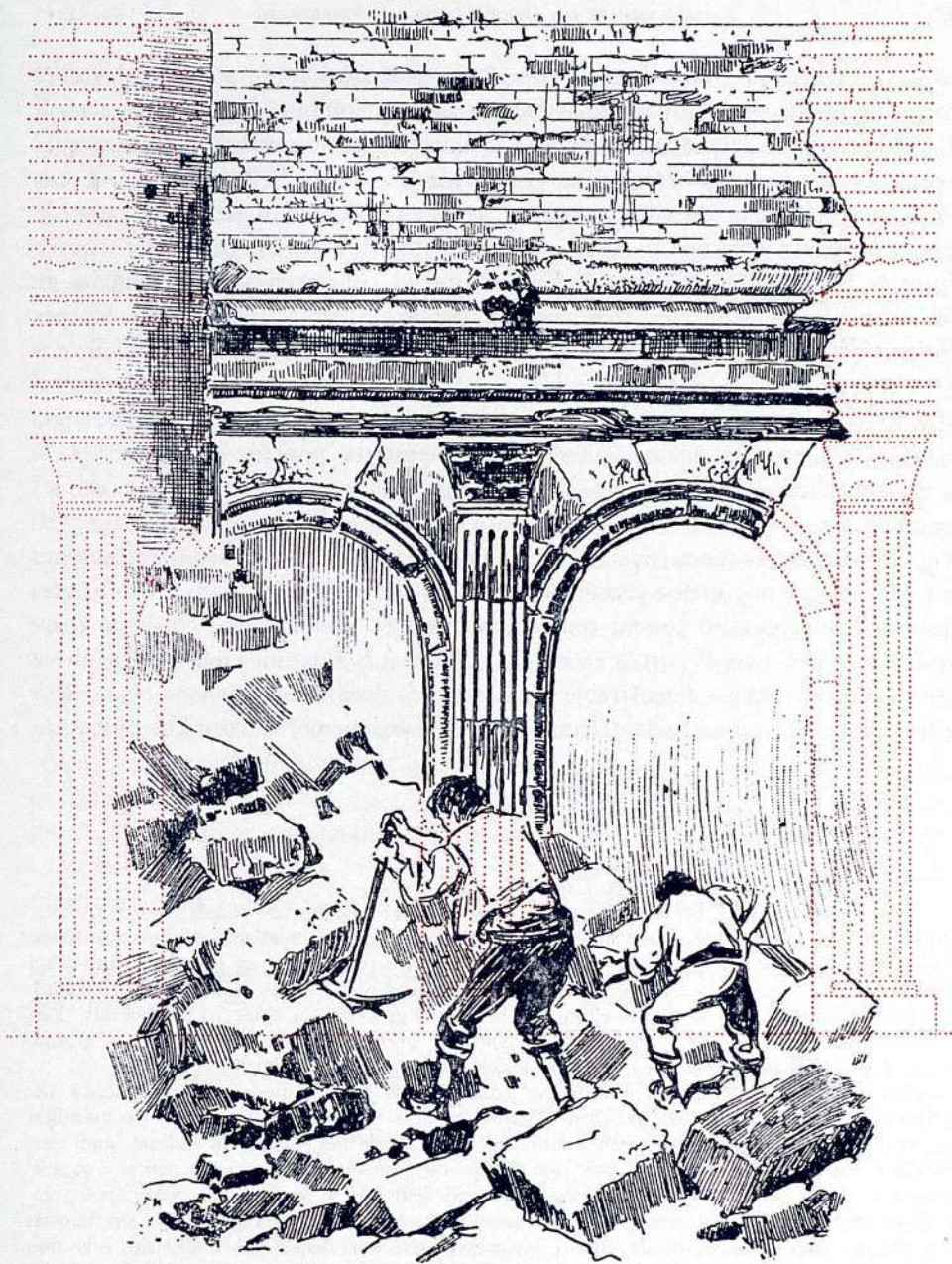
Fig. 15. Reconstrucció hipotètica (puntejat en vermell) de la porta del Regomir, en el disseny deixat per Puiggarí, al moment de la demolició. Es veu clarament l'aspecte de Porta Gemina típicament augustea (de CARRERAS CANDI, p. 92)
