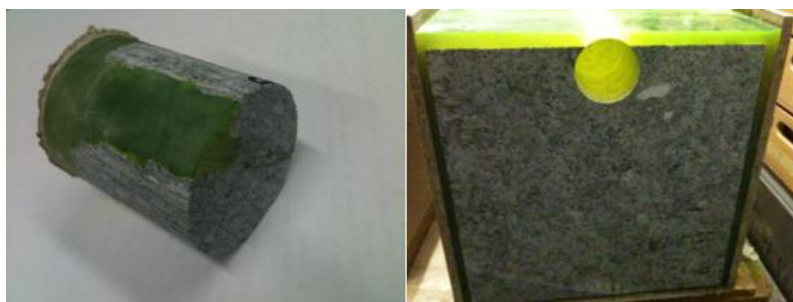
Abbildung 1.7: Gezogener Bohrkern aus der Gesteinsprobe direkt unter dem Schnitt mit der Diske
