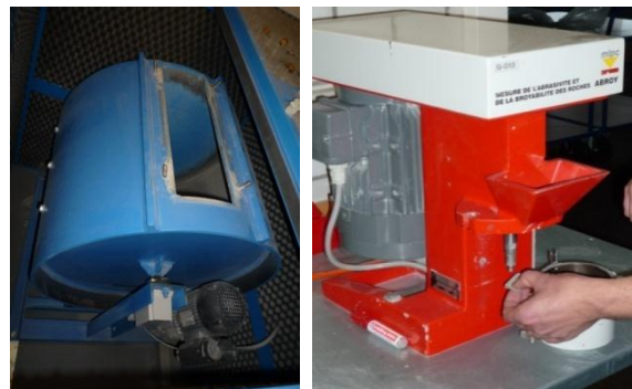
Abbildung 1.4: LA- und LCPC Tests
