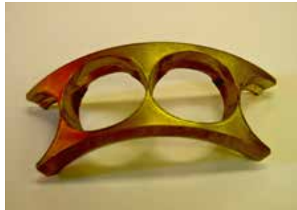
– Fig. 13: Cage fracture
