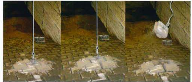
Abb. 10: Erforderliche Anhebung zum Herauslösen eines Standard Verkalit®-Deckwerksteins 180 mm
