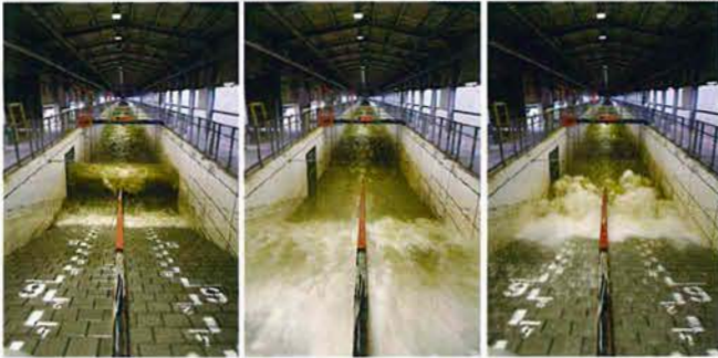
Abb. 6: Wellenbrechen (links), Wellenauflauf (Mitte) und Wellenablauf (rechts) auf einem 1:3 geneigten Deckwerk im Großen Wellenkanal in Hannover
