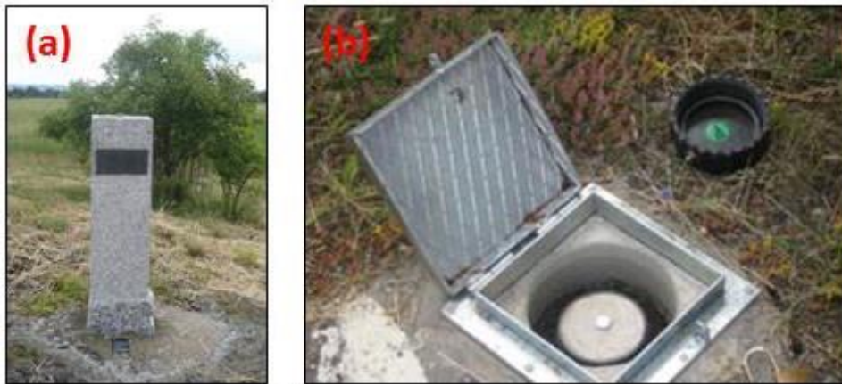
Abbildung 7: Höhenhauptpunkt Hutbigl bei Horn (NÖ). Neben dem (a) Monument befindet sich (b) die unterirdische Stabilisierung, die direkt in einem geologisch besonders stabilen Felsaufschluss („Gföhler Gneis“) fundiert ist.
