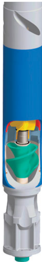
Abb. 6.62: Schematische Darstellung eines Gasseparators (Lea et al. 2005)
