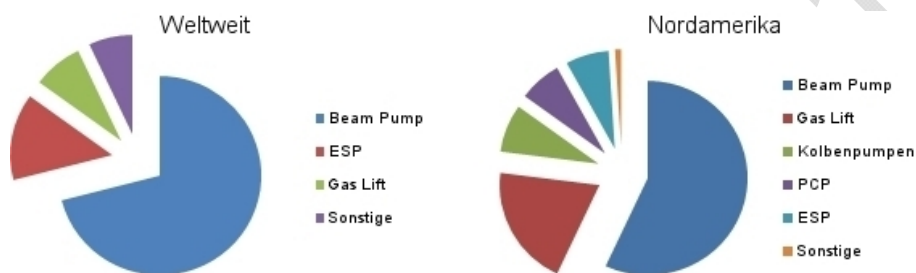
Abb. 6.64: Prozentuale Verteilung der weltweit und speziell in Nordamerika verwendeten Entwässerungsmethoden (vgl. Lea 2006)
