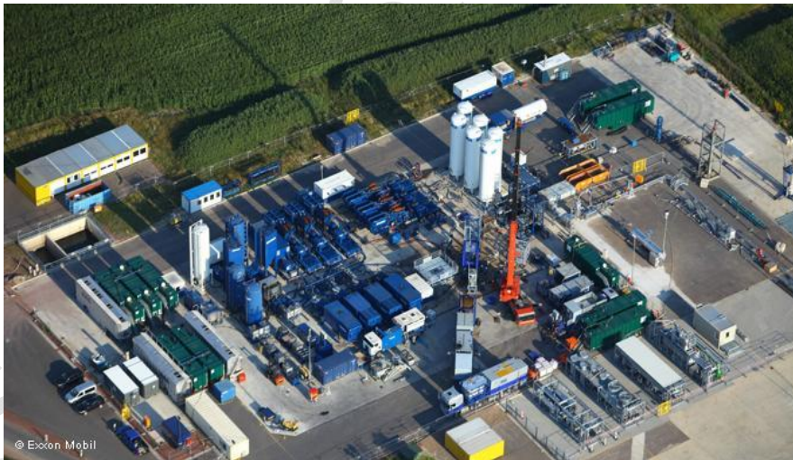
Abb. 6.10: Bohrplatz mit Neben- und Frack-Einrichtungen (Osterath 2011)
