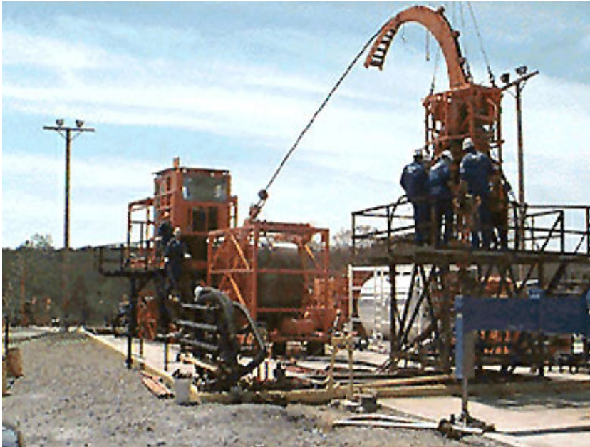
Abb. 6.28: Überträgige Einheit einer Coiled Tubing Drilling Unit mit Injector Head (Schlumberger 2007)
