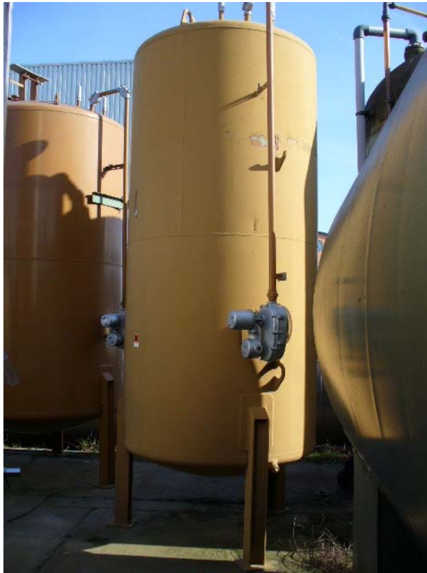
Abb. 6.13: Speicherbehälter nach DIN 6618 ( http://www.barth-tank.de/img/content/used_products/1211_1_.jpg )
