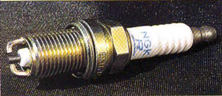
**Bauart:** Zwei/drei Elektroden, Luftgleitfunken parallel zum Kolbenboden (BKR7EKC Erstausrüstung für 1150er, BCP7ET alternativ für 1100er Motor)
