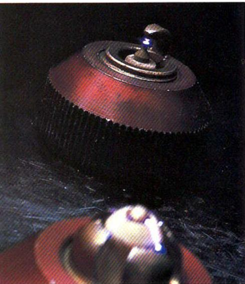
Im Hintergrund eine herkömmlich aufgebaute Ein-Elektroden-Kerze, im Vordergrund die Brisk DOR14LGS
