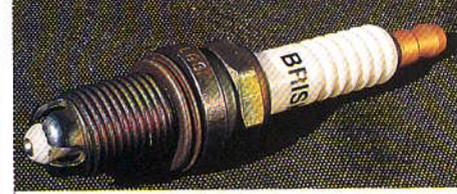
**Bauart:** Gleitfunkenkerze mit vier breiten, gezackten Elektroden auf „halber Höhe“. Multiple Funken ringsum
