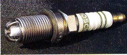
**Bauart:** Zwei Elektroden, Luftgleitfunken parallel zum Kolbenboden (FR6DDC Erstausrüstung für 1100er, FR6LDC alternativ für 1150er Motor)
