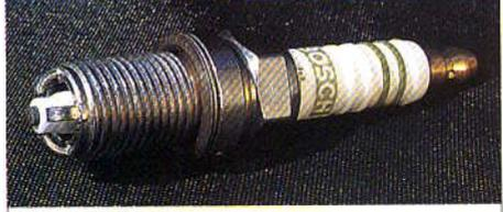
**Bauart:** Vier Elektroden, Luftgleitfunken parallel zum Kolbenboden (nur ein Funken, der sich immer den kürzesten Weg sucht. Vorteil: Lebensdauer)
