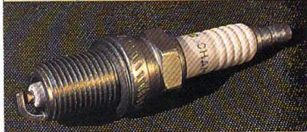
**Bauart:** Eine Elektrode, konventionelle Kerze ohne Besonderheiten (ausdrücklich nicht für 1150er geeignet)
