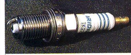
**Bauart:** Eine Elektrode mit integrierter U-Rille, Mittelelektrode aus Iridium (Vorteil: Lange Haltbarkeit trotz extrem dünner Iridium-Spitze)
