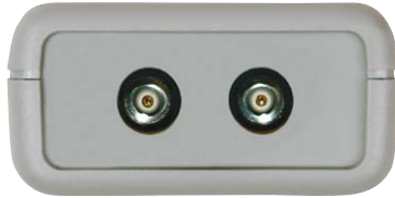
Simple Logger® II Modell L102 Die doppelt isolierten BNC-Anschlüsse sind für Zangenstromwandler mit BNC-Stecker geeignet
