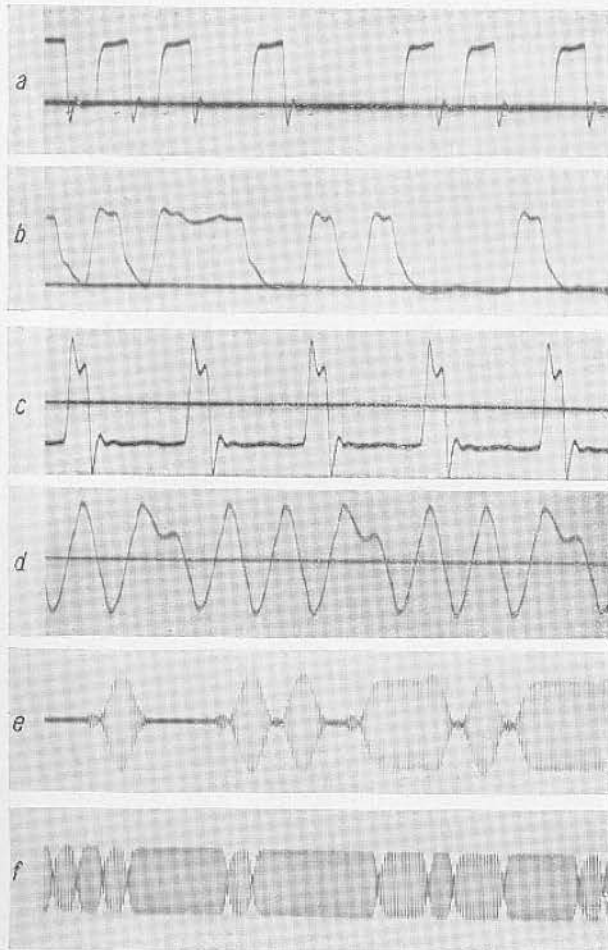
Abb. 12. Stromverlauf auf der Empfangsseite verschiedener Fernschreibübertragungssysteme
