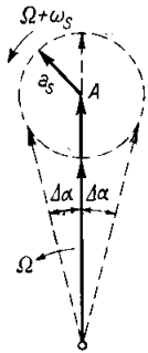
Bild 24. Phasen- und Amplitudenmodulation des Trägers A durch die Störschwingung \omega_s .
