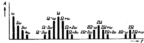
Bild 4. Frequenzspektrum am Ausgang eines Modulators A Amplitude, f Frequenz.
