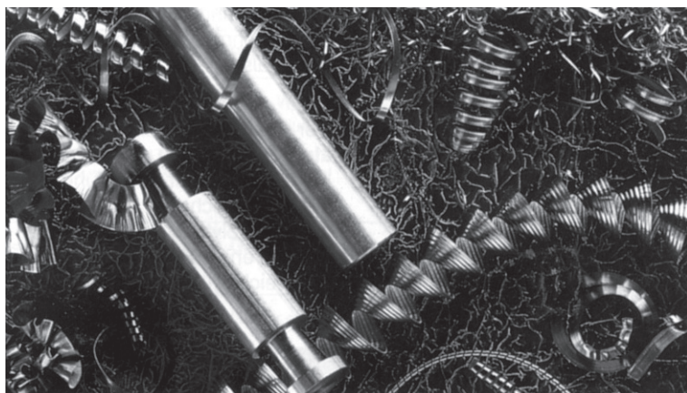
Obr. 7: příklady tvorby třísek při rozdílném obsahu síry
