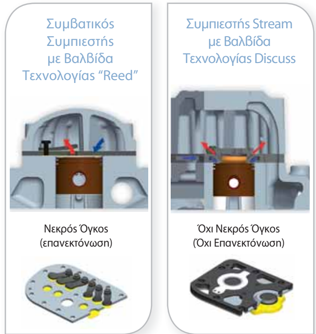
Σχέδιο 2. Η βασική διαφορά στην τεχνολογία Βαλβίδων μεταξύ συμβατικών και Stream συμπιεστή.
