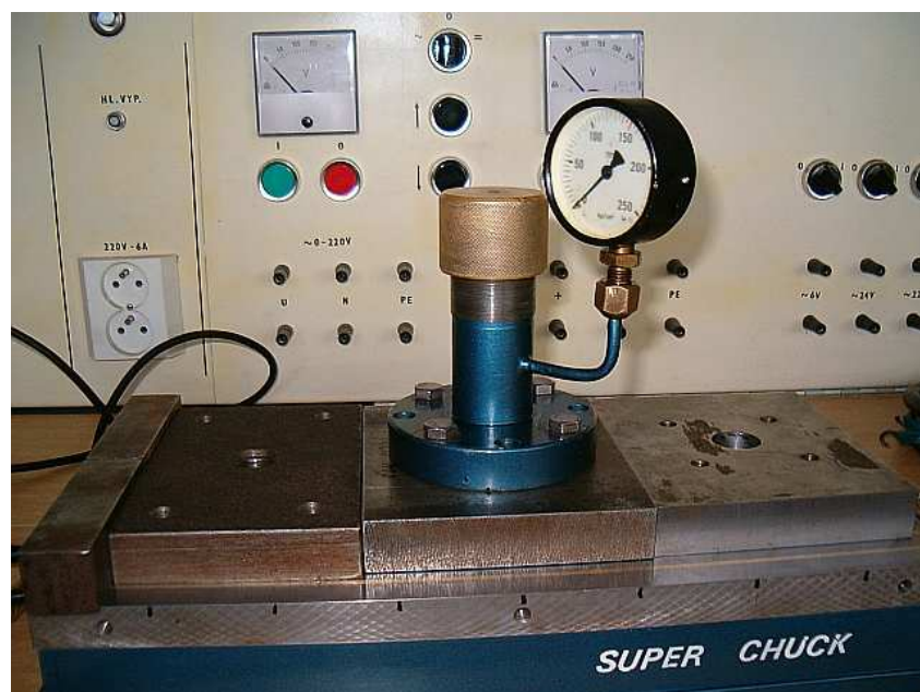
Obr. 37: Zakrytí adhezního měřidla ocelovými pláty
