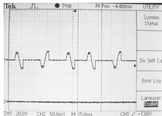
Obr. 51: Snižování intenzity magnetického pole demagnetizátorem
