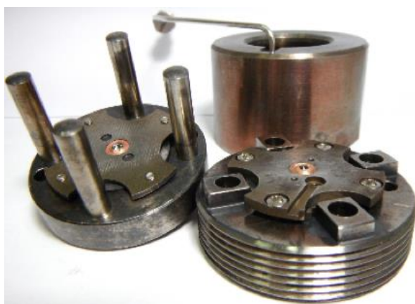
Figura 10. Cella a membrana con in evidenza le due incudini di zaffiro supportate ciascuna da un piattino a quattro bracci.
