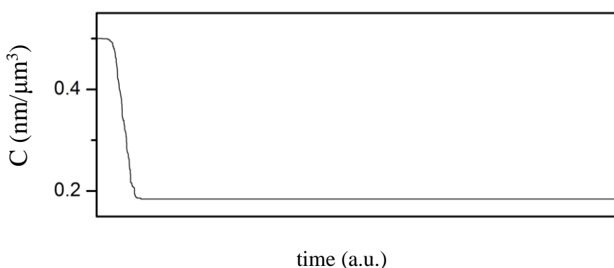
Figura 33. Simulazione dell'andamento della concentrazione durante il processo di fusione e di ricristallizzazione.
