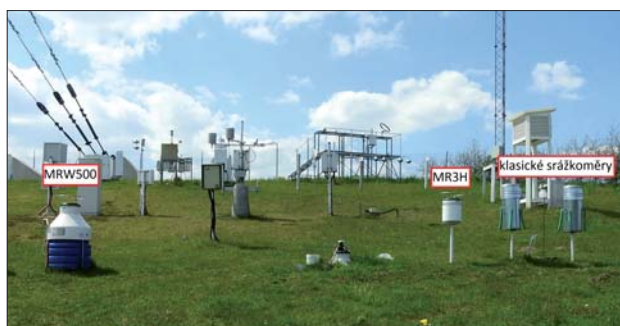
Obr. 4 Pohled na měřicí pozemek meteorologické stanice Košetice, váhový srážkoměr MRW500, člunkový srážkoměr MR3H a klasické srážkoměry pro manuální měření srážek.
