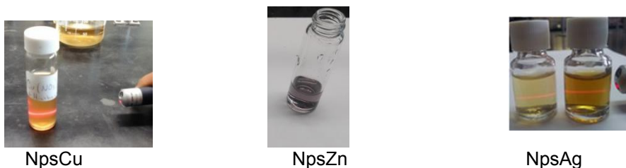
Figura 6. Disoluciones de nanopartículas obtenidas con el extracto de hierbabuena. a) Plata, b) Cobre y c) Zinc.
