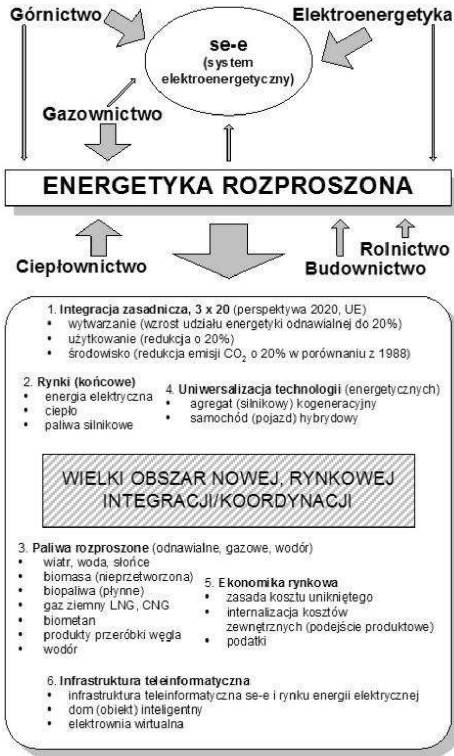
Rysunek 1. Miejsce i rola energetyki rozproszonej w relacji do systemu elektroenergetycznego i do tradycyjnych sektorów paliwowo-energetycznych oraz do potencjalnych obszarów ekspansji tej energetyki
