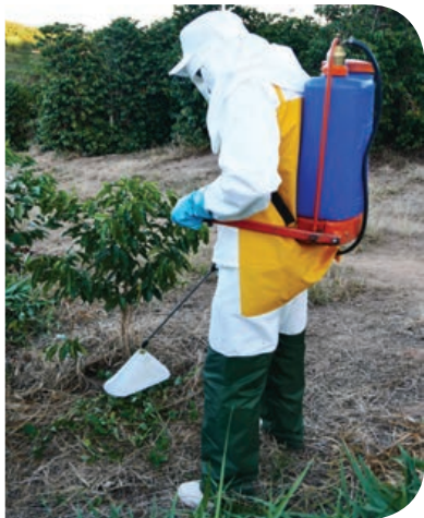
“Chapéu de Napoleão acoplado ao pulverizador costal pressurizado
