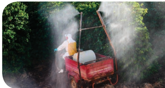
Triciclo com pulverizador adaptado
