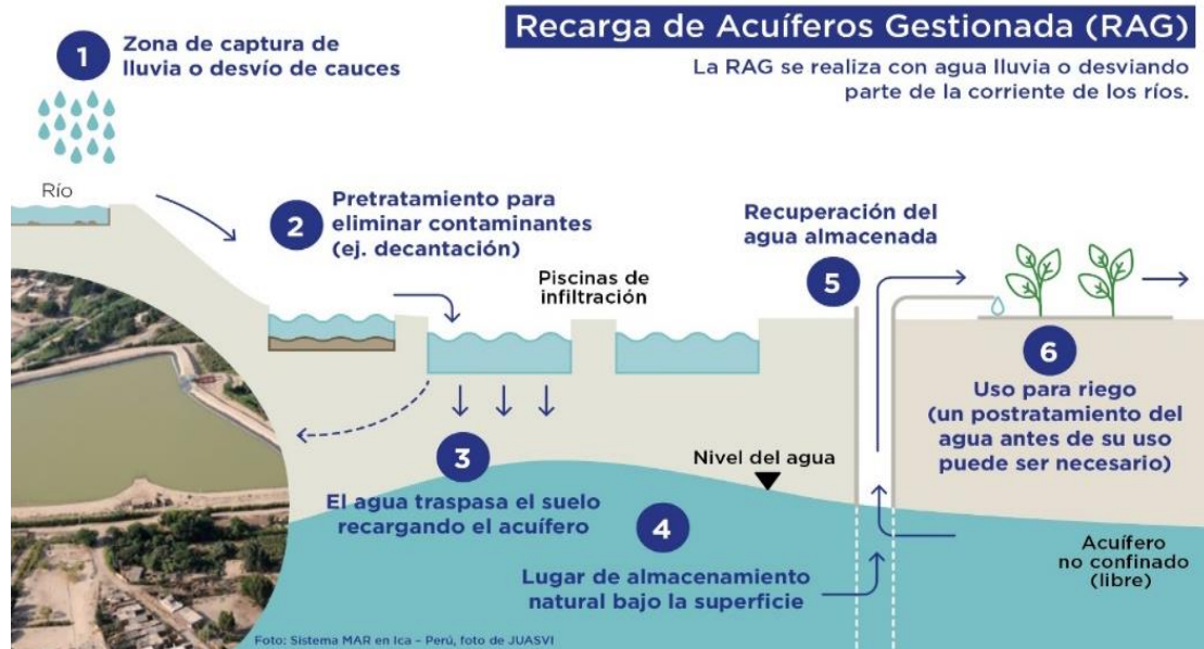
Figura 3. Ejemplo de la recarga de acuíferos gestionada con piscinas de infiltración para el sector agrícola. Elaboración propia.
