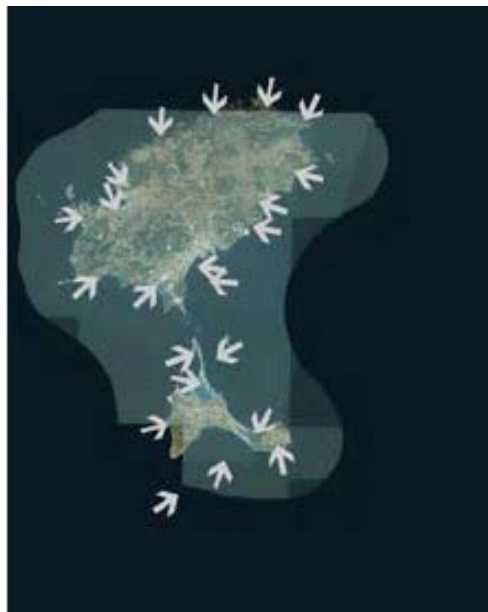
Figura 8.- Dirección del flujo medio de energía
