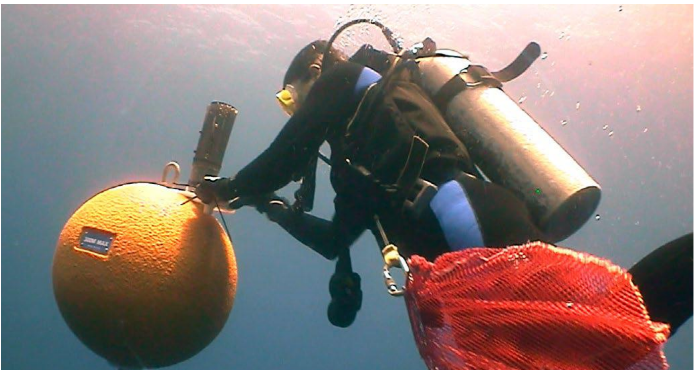
Instalación de una boya oceanografica bajo la superficie con instrumentación CTD-FI (YSI Sonde). (Imagen: R. Pépolas)
