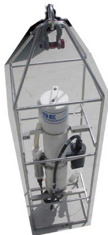
Instrumento Conductividad - Temperatura - Profundidad (CTD, por sus siglas en inglés) con jaula de protección para perfiles verticales e instalaciones fijas. (Imagen: B.Schaeffer)
