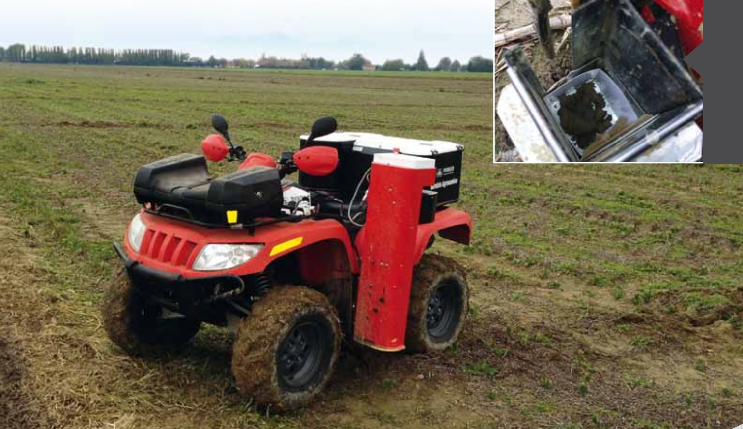
Figura 1: Quad equipaggiato con sistema meccanizzato di prelievo di campioni di terreno
