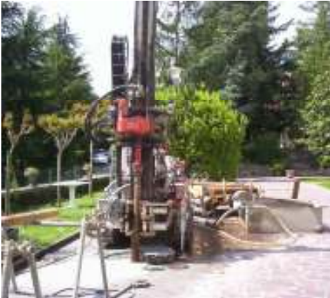
Esecuzione di sondaggio a carotaggio continuo alla profondità di 10 m presso cantiere a Tarzo (Tv)
