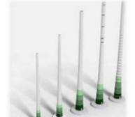
Mât            | Supporter la nacelle et le rotor                                                                                                                                         | Structure : 6 sections en acier<br>Diamètre de la base : 4,3 m<br>Hauteur du mât seul : 105,31 m
