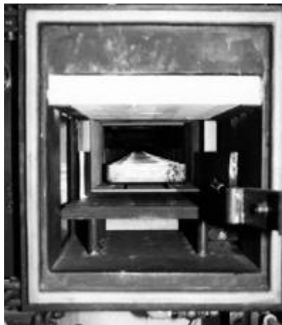
Blick in den Hubbalkenschacht durch den geöffneten Schieber. Größe der Chargenkörbe: 330mm x 330mm x 80mm
