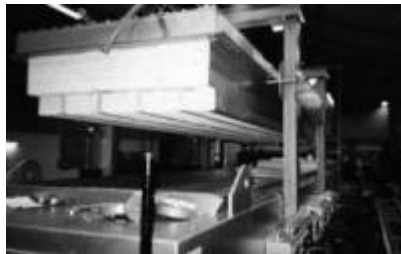
Komplettes Ofenoberteil der Sinterzone in angehobendem Zustand für Reparaturarbeiten
