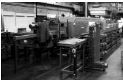
Der Einlassbereich eines WBS-Ofens mit Schleusensystem und Teilen der automatischen Aufbewahrung
