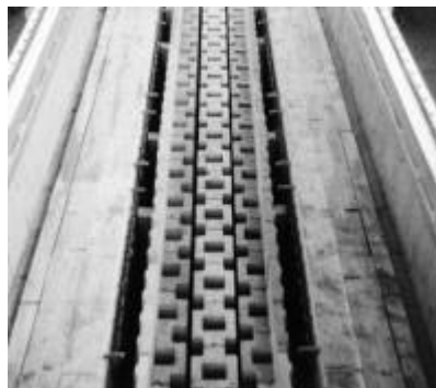
Blick auf den Ofenauslass mit Schleuse, Umsetzer und Dreifachförderband
