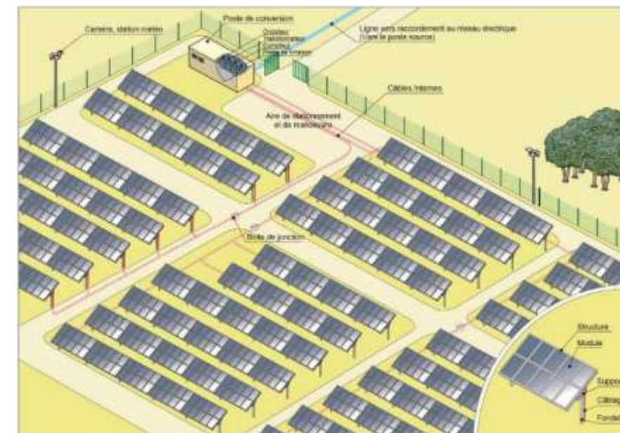
Figure 10 : Schéma de principe d'une centrale-type photovoltaïque
