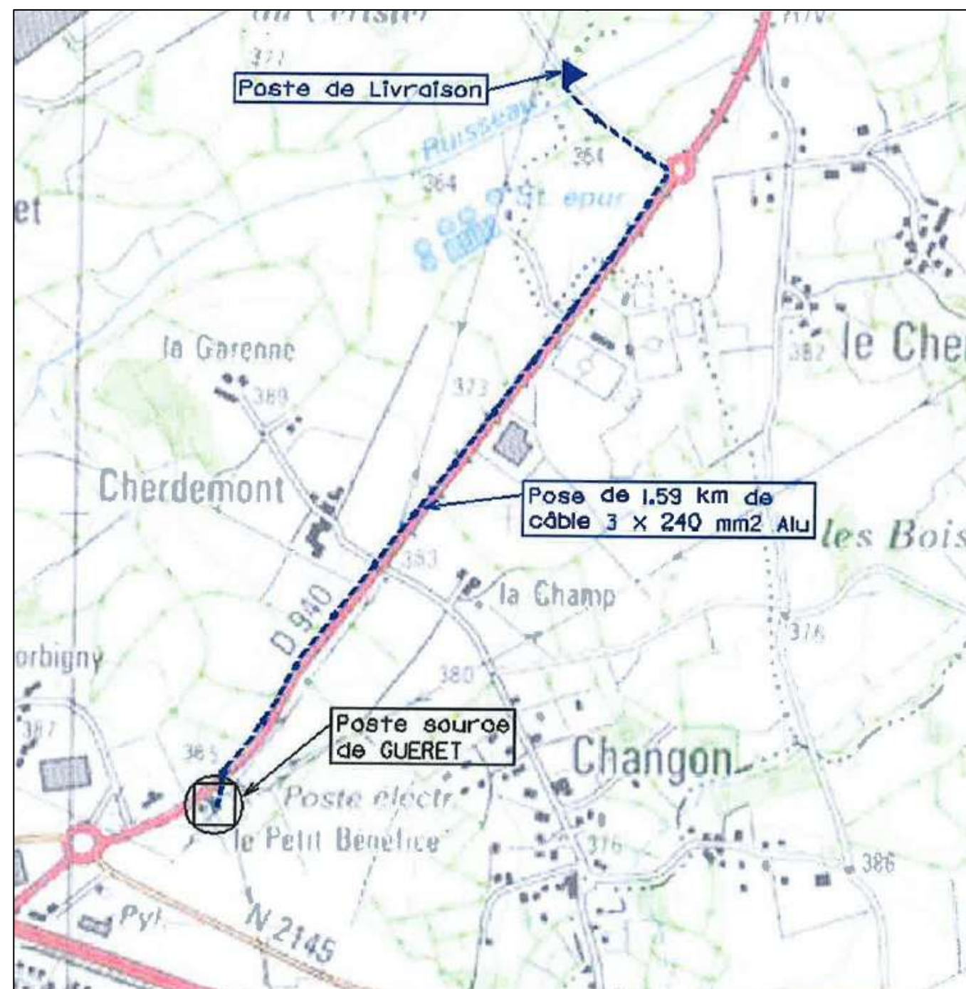
Figure 14 : Tracé du raccordement envisagé (Source Pré Etude Simplifiée ENEDIS)
