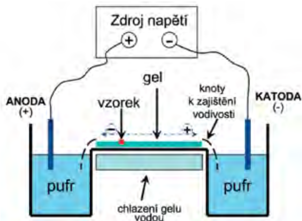
Obr. 56 Schéma elektroforetického uspořádání pro zónovou elektroforézu na gelovém nosiči.
