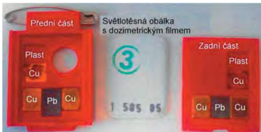
Obr. 31 Rozložený filmový dozimetr. Film je v kazetě kryt z obou stran filtry, zachycujícími jednotlivé typy záření. Plastický filtr a měděné filtry různých tlouštěk slouží k vyhodnocení \beta a RTG záření. Uprostřed je filtr z olova pro stanovení intenzity \gamma záření. Po vyvolání filmu se porovnává zatmavení jednotlivých nekrytých a krytých částí dozimetru.
