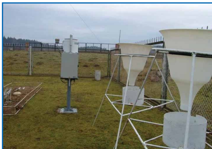
Ryc. 34. Chwytałce (kolektory) opadów atmosferycznych do badania ich składu chemicznego znajdują się w obrębie ogródka meteorologicznego stacji badawczej UAM w Storkowie na Pojezierzu Drawskim (Szpikowski 2018). W centralnej części zdjęcia widać chwytałce „opadu mokrego” z czujnikiem i pokrywą, a po prawej dwa chwytałce „opadu całkowitego” (polietylenowe leje na metalowych trójnogach).
