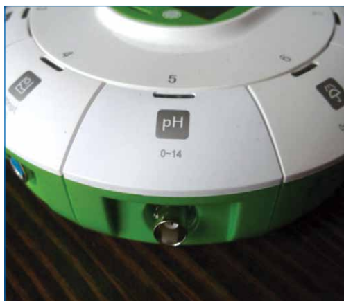
Ryc. 37. Moduł do pomiarów pH miernika SenseDisc. Zwróć uwagę na widoczne gniazdo BNC do podłączenia elektrody kombinowanej.
