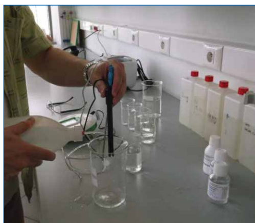
Ryc. 42. Oplukiwanie elektrod po pomiarze wodą destylowaną z tryskawki (po lewej), a następnie osuszanie ich powierzchni za pomocą papierowego ręcznika przed wykonaniem następnego pomiaru.
