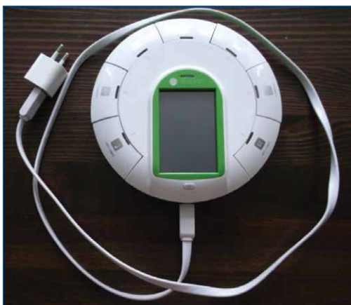
Ryc. 36. Czujnik SenseDisc z podłączonym zasilaczem sieciowym.
