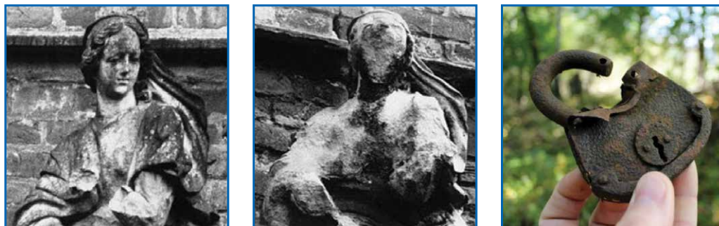
Ryc. 30. Przykład skorodowanej przez kwaśne opady rzeźby (po lewej) i metalowej klódki. Rzeźba została wykonana z piaskowca i znajduje się na terenie Westfalii w Niemczech. Zdjęcie po lewej stronie pochodzi z 1908 r., a po prawej z 1968 r. https://www.researchgate.net/publication/236616249_Legacy_Problems_in_Urban_Geochemistry/figures?lo=1 i http://www.sprawnyfachowiec.pl/artykul/919/kwasne-deszcze .
