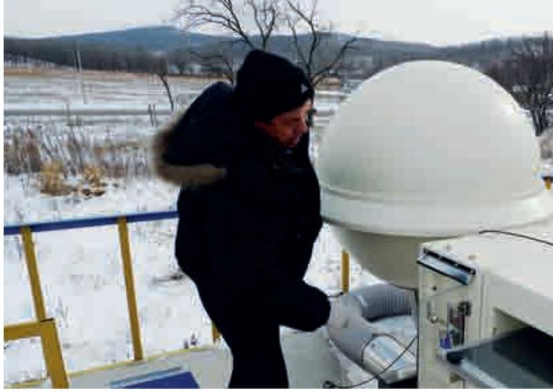
محطة رصد النويدات المشعة RN58 في أوسوربيسك، الاتحاد الروسي، التي اعتمدت في حزيران/يونيه ٢٠١٠: تغيير المرشح في المعائن الهوائي (جهاز جمع العينات من الهواء). محطة رصد النويدات المشعة RN58: نزع المرشح من المعائن الهوائي قبل ضغطه.
