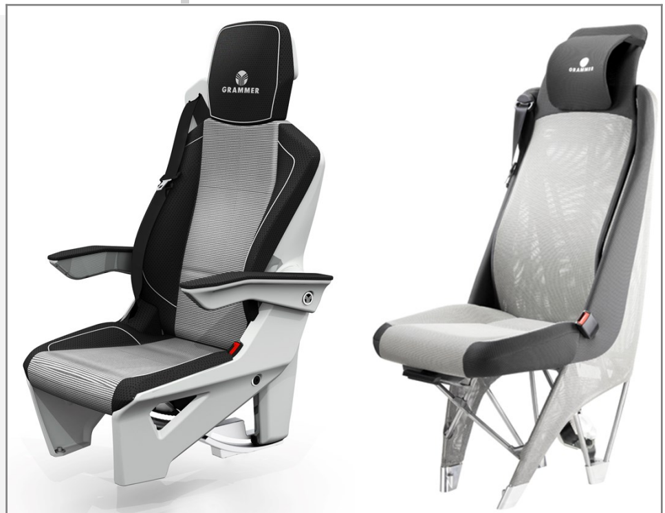
Abb. 33: Leichtbau-LKW-Sitz aus faserverstärktem Kunststoff (links) und hochfesten Stahl (rechts) [61]
