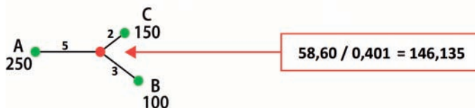
Figura 14.4. Esempio di applicazione dell'interpolatore IDW. I valori delle misure più vicine al punto da stimare (in rosso) hanno un peso maggiore di quelli più lontani
