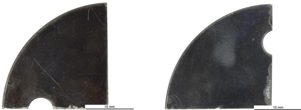
Abbildung 8.24: Probe nach 2 (links) und nach 8 Zyklen (rechts)
