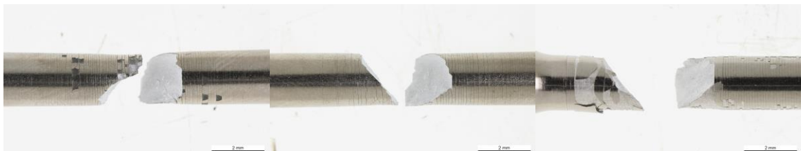
Abbildung 4.27: Zugproben im Ausgangszustand von MTO 0 (links), MTO 2 (Mitte) und MTO 3,5 (rechts); leichtes Abplatzen der Schicht bei MTO 0 und starke Delamination bei MTO 3,5
