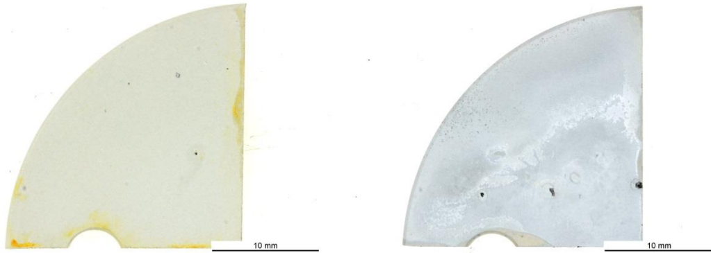
Abbildung 8.39: PEO 2 beschichtete Probe nach 2 (links) und nach 8 Zyklen (rechts)
