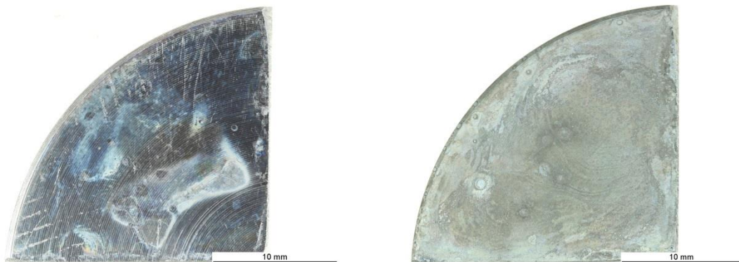
Abbildung 8.9: Probe nach 2 (links) und nach 39 Zyklen (rechts)
