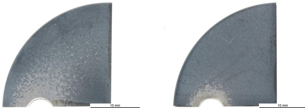
Abbildung 8.42: PEO 1 beschichtete Probe nach 2 (links) und nach 8 Zyklen (rechts)
