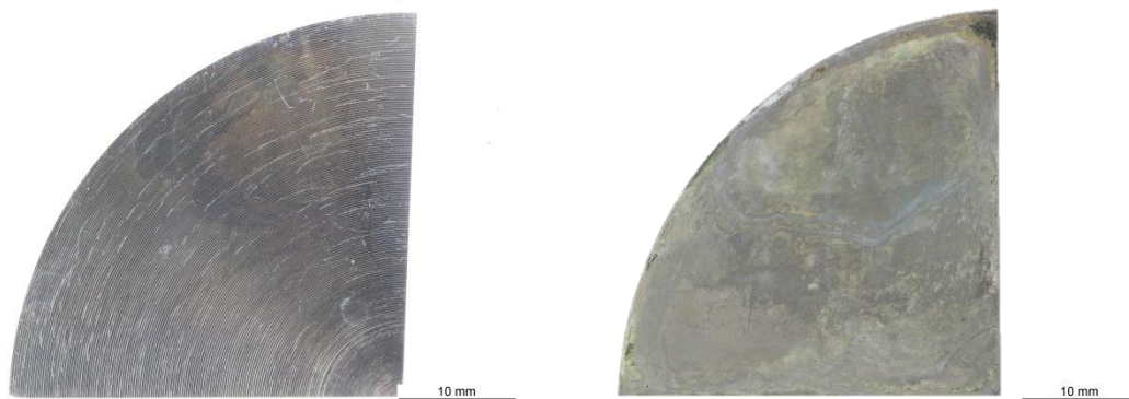
Abbildung 8.62: Probe nach 2 (links) und nach 35 Zyklen (rechts)
