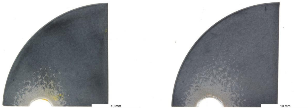
Abbildung 8.48: PEO 1 beschichtete Probe nach 2 (links) und nach 8 Zyklen (rechts)
