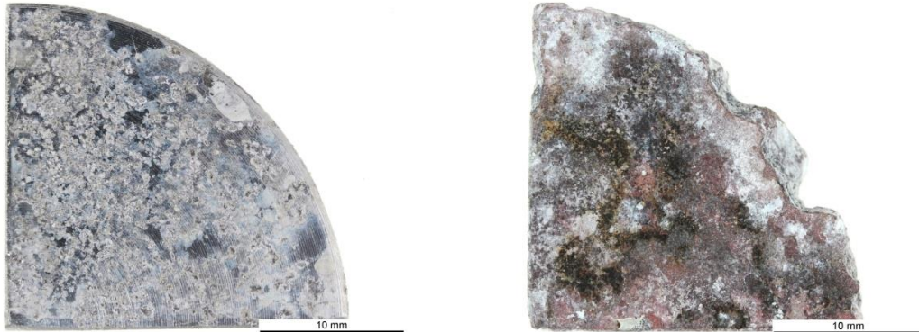
Abbildung 8.1: Probe nach 2 (links) und nach 39 Zyklen (rechts); bereits nach kurzen Versuchszeiten ist die Oberfläche mit einer geschlossenen Salzschrift bedeckt
