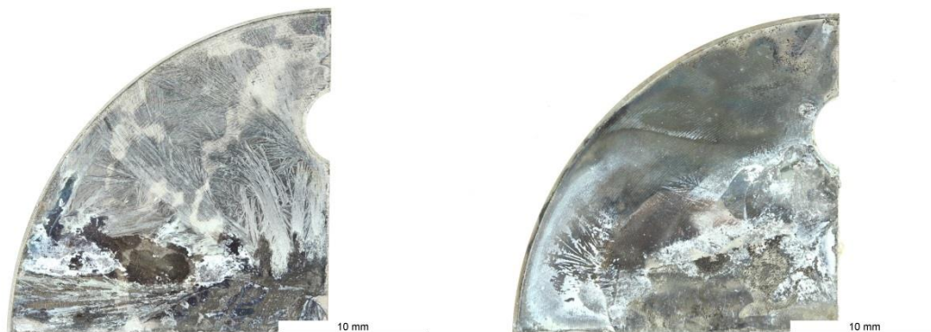
Abbildung 8.20: Probe nach 2 (links) und nach 8 Zyklen (rechts)
