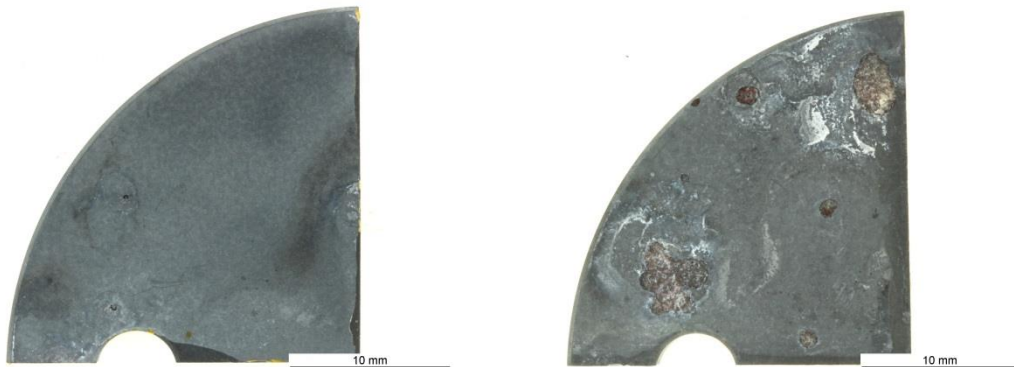
Abbildung 8.30: PEO 1 beschichtete Probe nach 2 (links) und nach 16 Zyklen (rechts); mit zunehmender Zyklenzahl platzen Bereiche der Beschichtung ab
