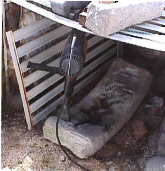
Abbildung 4: Versuchsstand für Dauertests der Meißelkralle auf Granit
