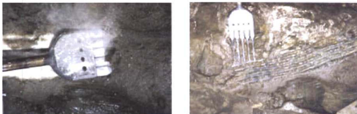
Abbildung 9: Naturstein-/Granitbearbeitung mit der Meißelkralle
