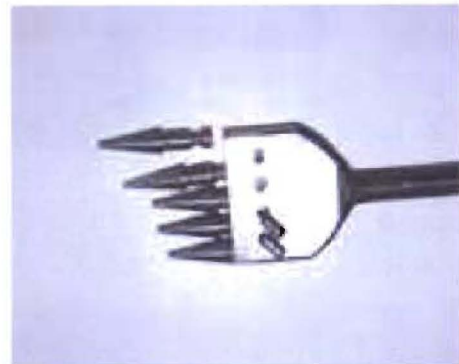
Abbildung 2: Meißelkralle mit austauschbaren Spitzen
