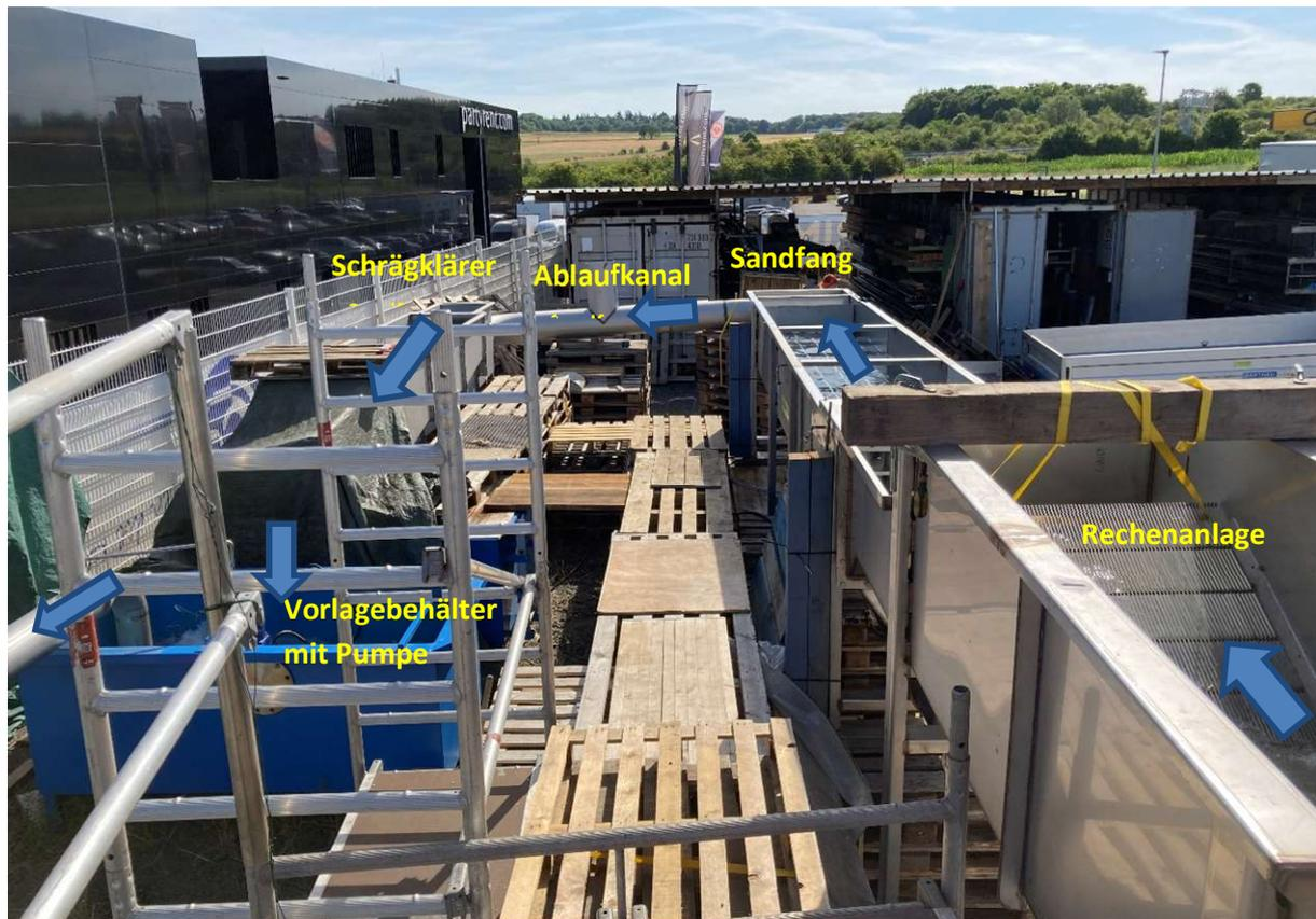
Abbildung 5: Versuchsanlage, Foto aufgenommen vom Podest der Sandzugabestelle
