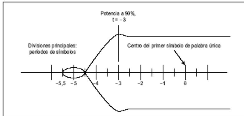
Figura 6.1. Estabilización de potencia del transmisor
