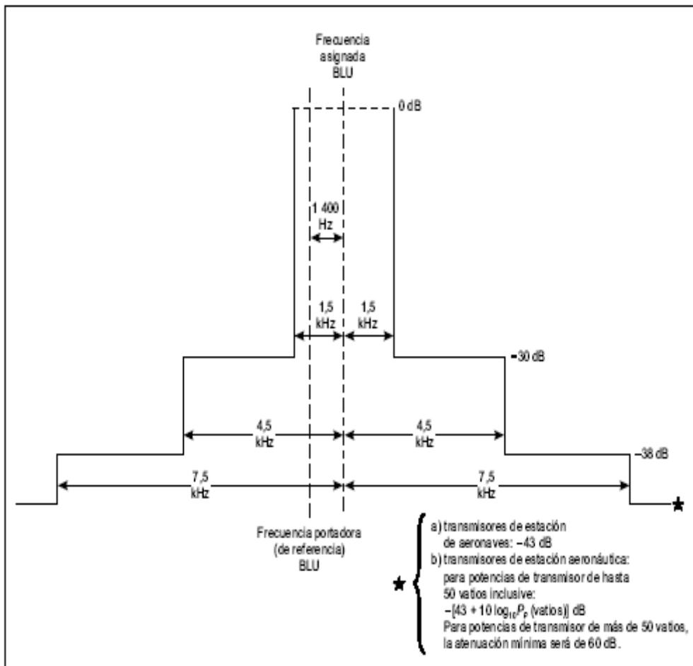
Figura 2-2. Límites del espectro requeridos (en cuanto a la potencia máxima) para los transmisores de estaciones de aeronave instalados inicialmente después del 1 de febrero de 1983 y para los transmisores de estaciones aeronáuticas que se utilicen después del 1 de febrero de 1983
