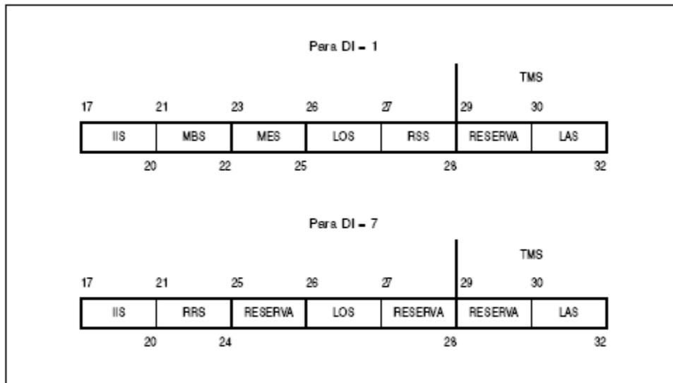
Figura 5-1. Estructura del campo SD
