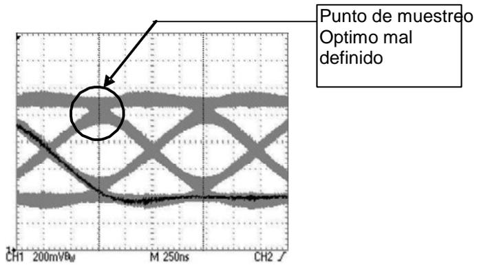
Figura 12-4 Diagrama en ojo con distorsion
