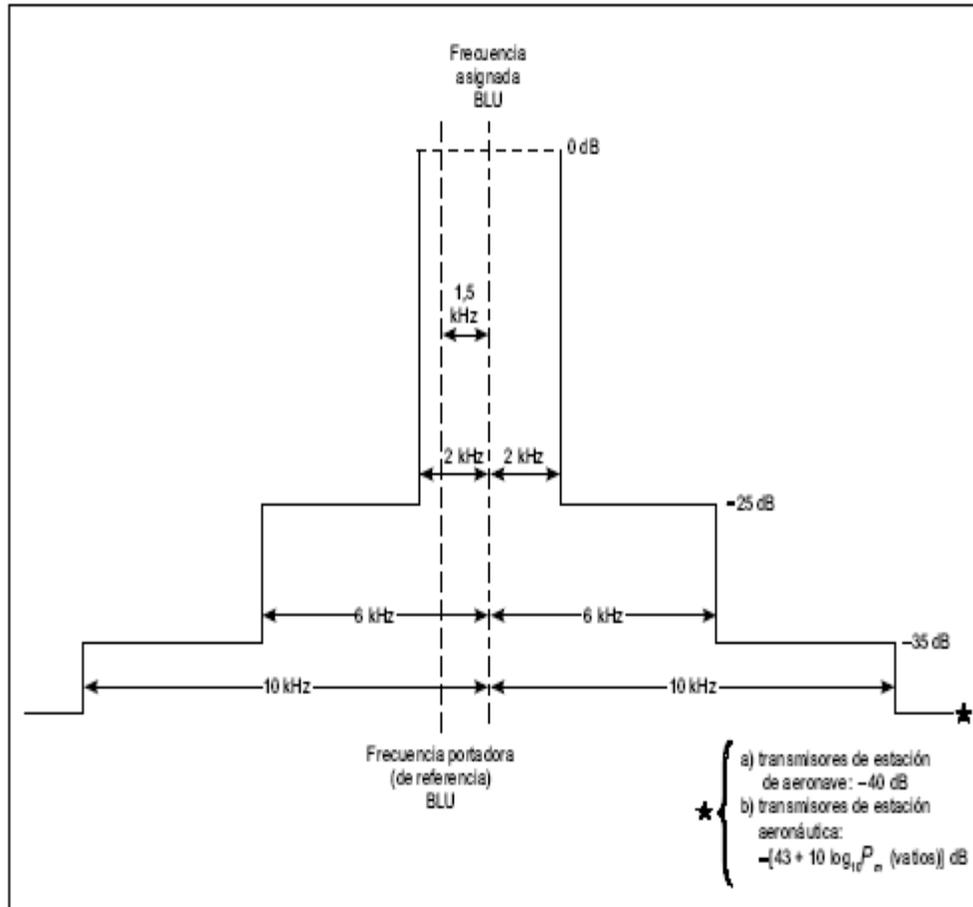
Figura 2-1. Límites del espectro requeridos (en cuanto a la potencia media) para los tipos de transmisores de estaciones de aeronave y para los transmisores de estaciones aeronáuticas instalados inicialmente antes del 1 de febrero de 1983
