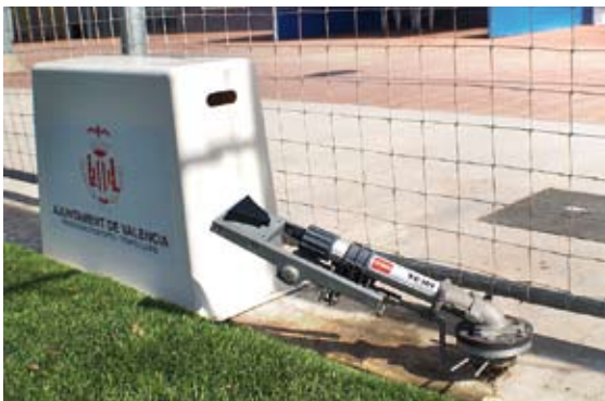
Cañón de riego de largo alcance y protector de fibra.
