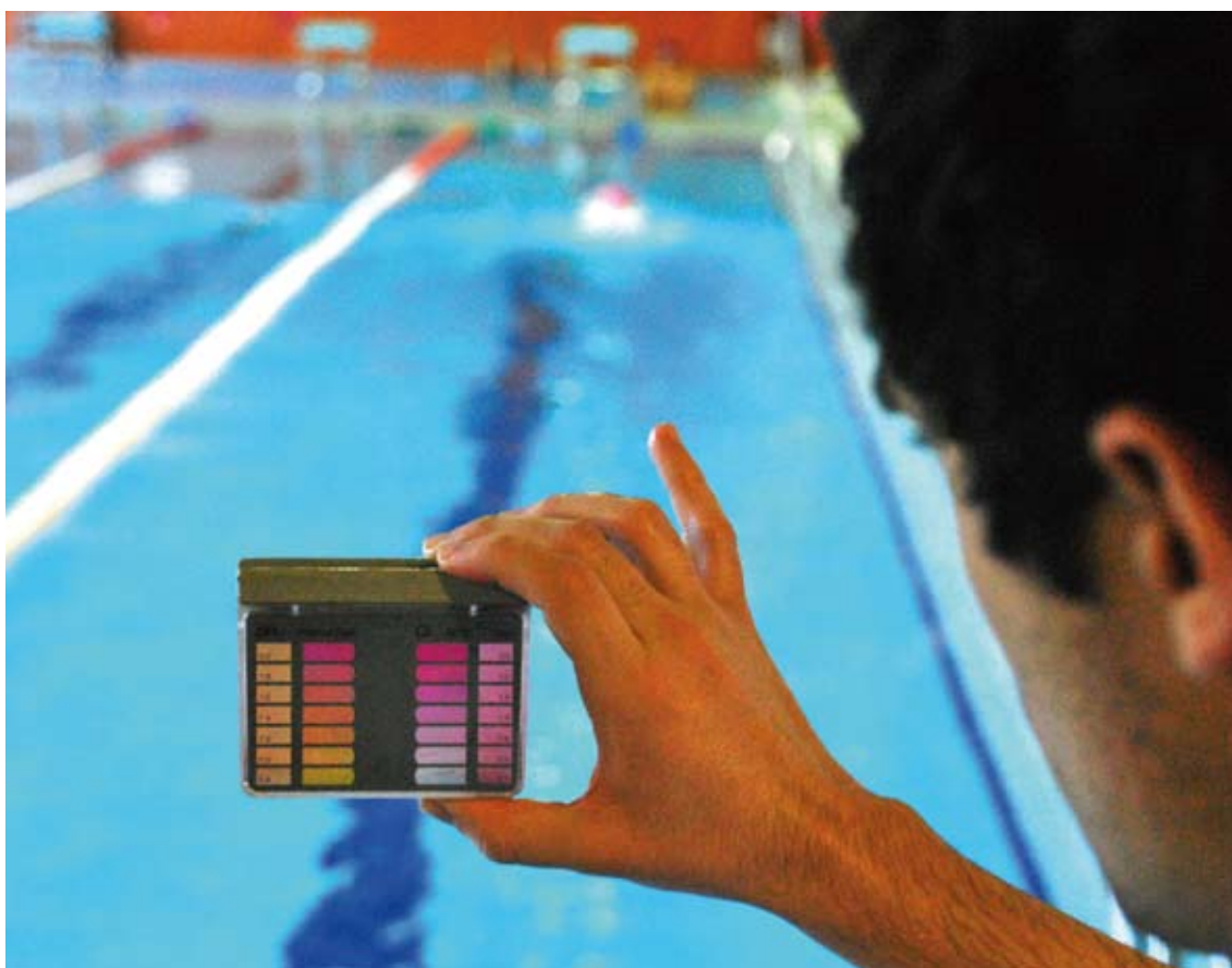
Analizador colorimétrico de desinfectante y pH.
