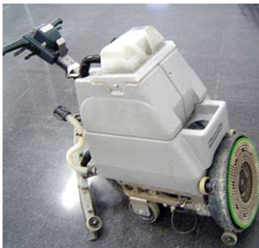
Máquina fregadora rotativa con aspiración de agua.
