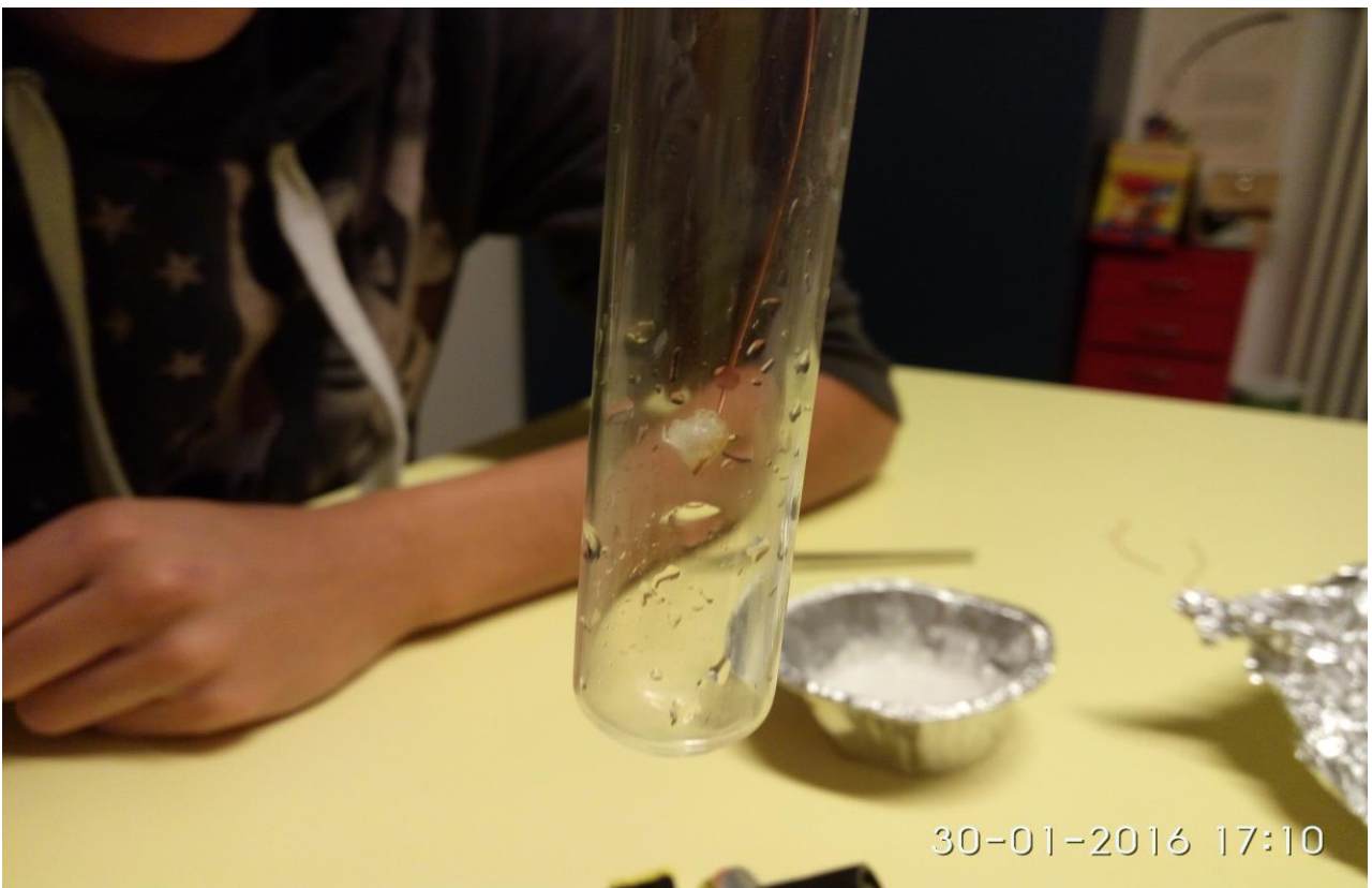
Cristallo di allume di rocca ottenuto con la tecnica di cristallizzazione per raffreddamento.
