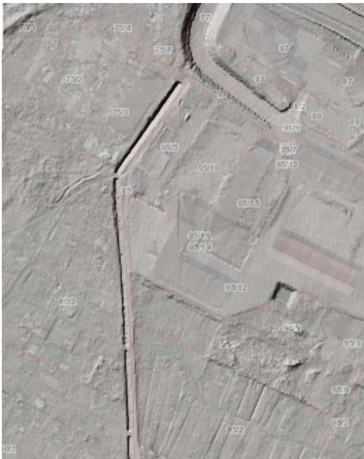
Ryc. 136. Rów na obrzeżu ogrodów działkowych między ul. Słowackiego a torami kolejowymi będący kanałem doprowadzającym wodę pitną do miasta (zwanym Röhrgraben ) – elementem systemu wodociągowego z 1528 roku. Wg: http://mapy.geoportal.gov.pl/imap/
