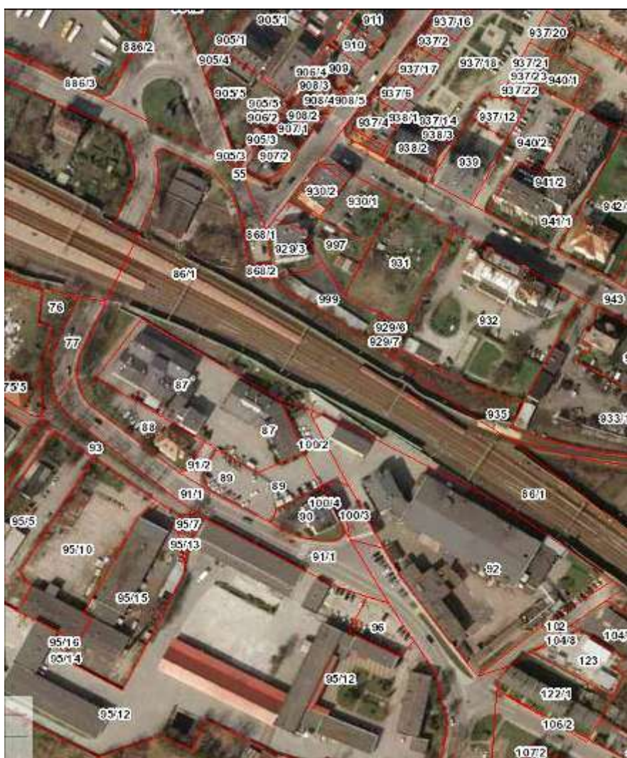
Ryc. 135. Pozostałość zlikwidowanego odcinka drogi z Brzegu do Starego Brzegu (której przebieg zmieniono na początku XX w. w związku z budową wiaduktów kolejowych) w postaci podziałów parcelacyjnych leżących na przedłużeniu ul. Trzech Kotwic i zachowujących dawną działkę drogową (parcele nr 168/1, 168/2, 100/2, 100/3. Wg: http://mapy.geoportal.gov.pl/imap/
