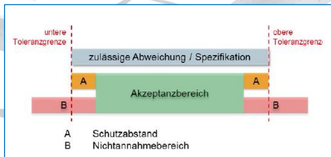
Abb.3 Darstellung zur Definition einer binären Entscheidungsregel. Der Gegenstand wird als konform akzeptiert, wenn der gemessene Wert innerhalb des Akzeptanzbereiches liegt. Andernfalls wird die Nichtkonformität bescheinigt.
