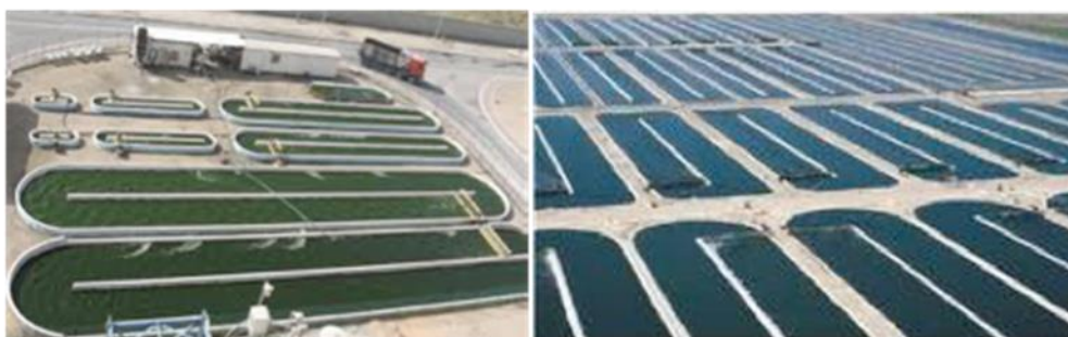
Figura 10.20. Sistema de cultivo de algas del tipo de carrusel abierto con circulación del medio de cultivo.
