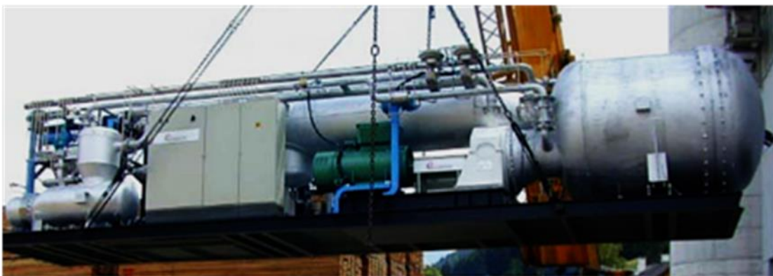
Figura 10.40. Módulo completo caldera-turbina con ciclo ORC. (Fuente SEEGER ENGINEERING AG).
