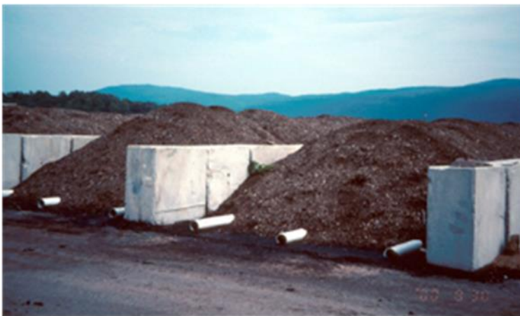
Figura 10.53. Reactores verticales de compostar.
