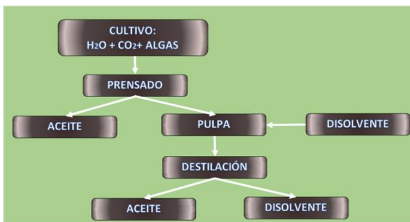
Figura 10.19. Esquema básico de obtención de aceite de algas.
