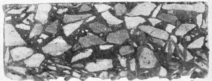
Fig. 1. — Béton asphaltique — Classe N° 2.
